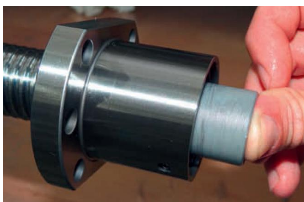
Obr. 4.11: Demontáž matice pomocí montážního pouzdra
