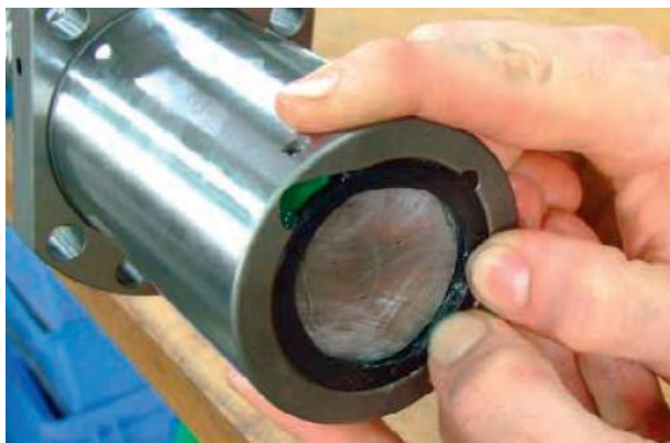
Obr. 4.7: Přidržování stěrače během pomalého našroubovávání matice na závit
