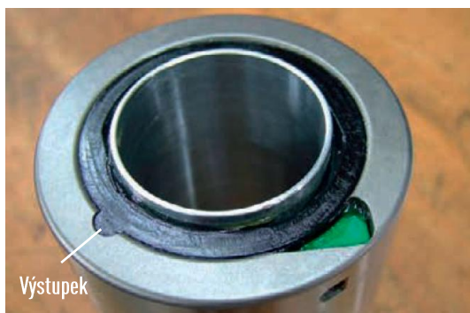
Obr. 4.4: Zajištění správného nasazení stěračů před montáží
