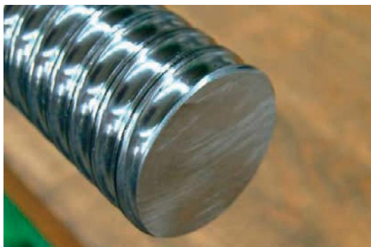
Obr. 4.3: Konec závitu před montáží stěrače z NBR
